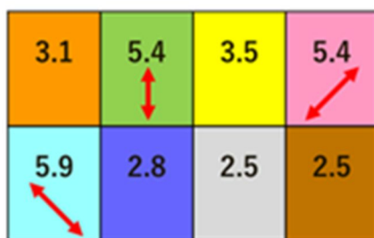
図 3: 細分類された部位のそれぞれのひずみと関節縫合を行った方向 (赤矢印) の一例。本例では全体の平均のひずみが 3.9 であり、それより大きい部位に縫合を行った。
