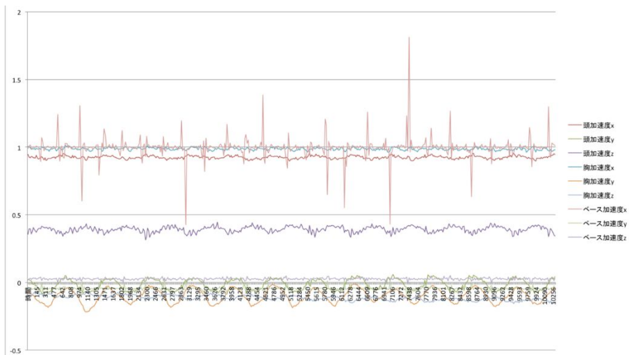
図 6 周期 800 ミリ秒で揺動させたときのベース(青色の座面)の加速度とそれに対する体の反射運動に伴う頭部や胸部の加速度
