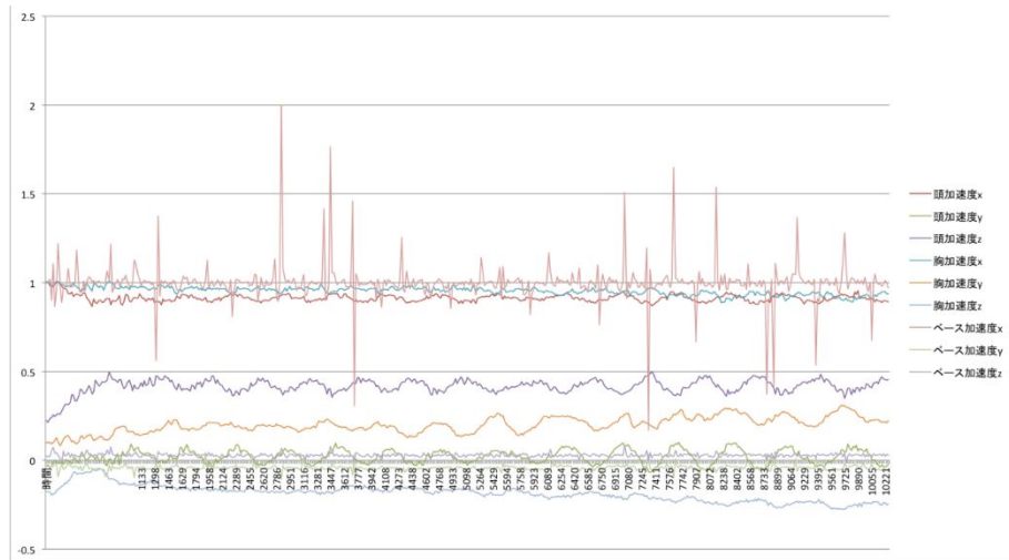
図 5 周期 600 ミリ秒で揺動させたときのベース(青色の座面)の加速度とそれに対する体の反射運動に伴う頭部や胸部の加速度
