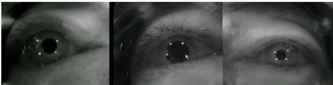
図 10 提案手法で眼球運動計測用赤外線参照光のメガネからの反射を除去した例
