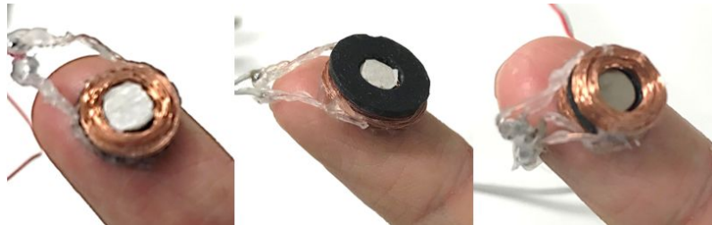
図 3 (左)皮膚に貼付する高效率振動子
