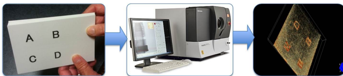
図 1 吸収型の X 線 CT を使った冊子体三次元画像の取得
