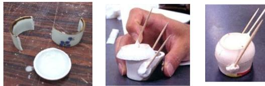
図4. 磁化を用いる破片からの元の製品への復元.
