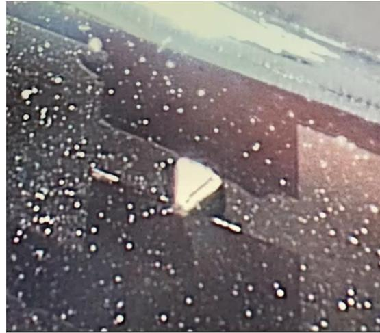
図4. 通電によりピラミッド形状の陰極を加熱した際の光学顕微鏡像.
