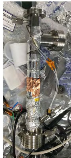
左図：液体キセノン純度モニターでのキセノン固化試験 右図：液体キセノン純度モニター
