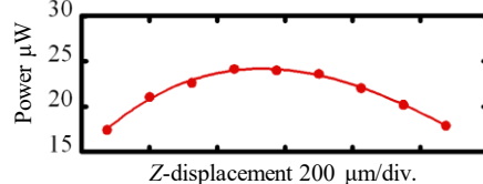
(b) センサ変位と反射光光量の関係
