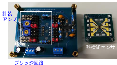
図6 試作した信号処理回路基板
