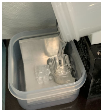
Fig.4-(b) 液状ゴムの注入
