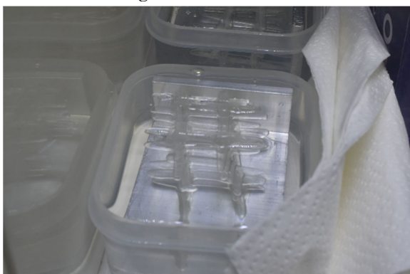
Fig.3-(b) 液状ゴムの注入と重合
