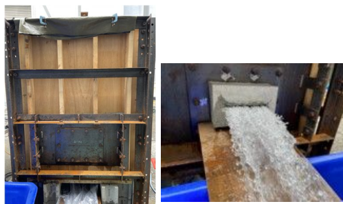
(c)外観 (d)開口部からの浸水
