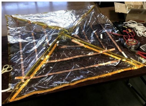
図1 電線を配置した膜構造モデル
