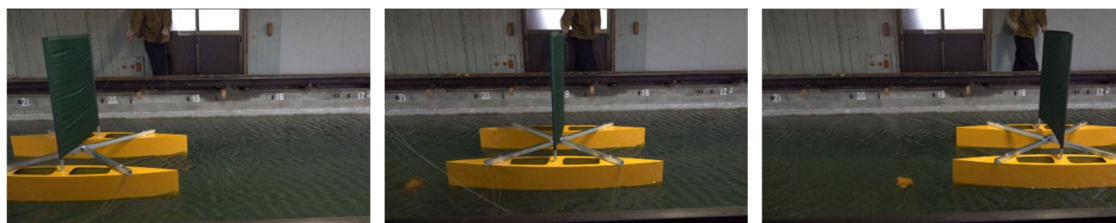
図2 定常風下での帆走試験
