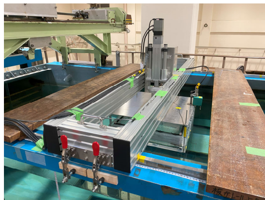
図2 回流水槽に設置された水害現象再現装置
