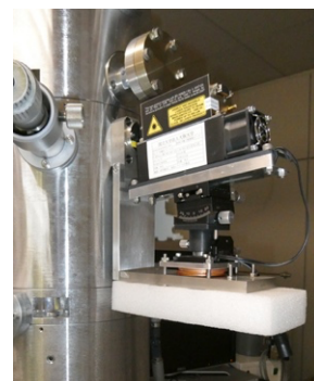
図1. TEMに設置した半導体レーザーの外観。
