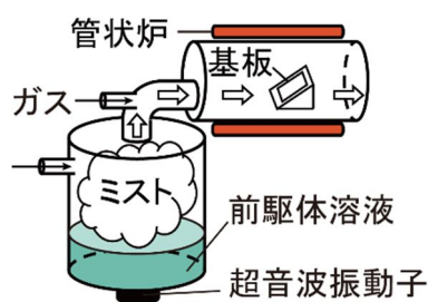
図2. ミスト化学気相成長法の構成。
