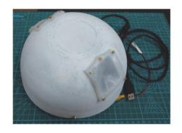
左図が試作したプロトタイプである。この試作機では形状変化機構は一つしか実装されていないが、ラック・アンド・ピニオン機構を内蔵し、シリコン膜が複数の痛みを表す形状に変化する。さらには変化の周波数を制御することも可能で、これらの組み合わせによって予備実験で抽出された要件を満たすことを確認した。萌芽的な研究事例であるが、着想自体の新規性が評価されて、2020年度の人工知能学会全国大会にて優秀賞を受賞した。
