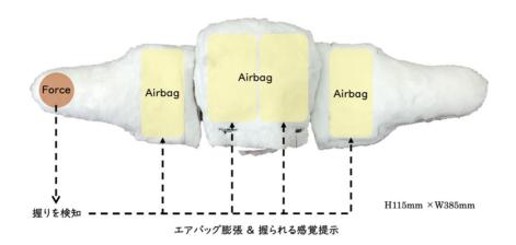
予備実験を繰り返しながらエアバッグの数や配置など基本構成を検討していき、上図のような構成に行き着いた。続いて、物理エージェントデバイスが有すべきもう一つの要求である、ユーザのエージェンシー認知を喚起させる外観の検討を行い、最終的に下図のような外観を有する物理エージェントデバイスを開発するに到った。
