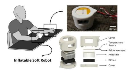
物理エージェントデバイスについて、第1プロトタイプは硬質な素材を3D printing して作成し、ユーザが握ることとユーザを握ることの2種基本要求仕様を満たす制御上の設計を検討した。しかしながらこの過程で素材自体の変更の必要性を強く実感するに到り、第2プロトタイプは人工毛皮素材とエアバッグアクチュエータで開発することにした。
