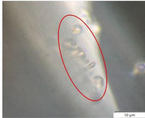
図 10 合成した人工流体包有物
