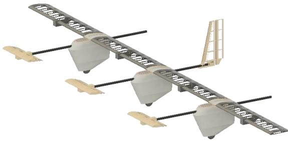
図 3. 技術実証機の 3DCAD 図面
