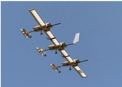
図 5. 能動空力弾性制御の技術実証機
