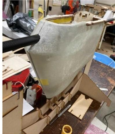
図 4. FRP 積層部品を利用した胴体構造の製作
