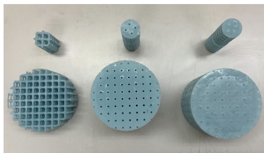
図 1 3D プリンターで造形した試料(右から SC, RES2, RES2-g3x3)
