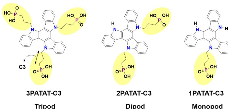
合成した **PATAT** 誘導体の DMF 溶液を金属酸化物 (ITO) 上にスピコートすることで **PATAT** 誘導体の薄膜を作製した。水の接触角度を測定した結果, 何も塗っていない ITO 基板では  $8^\circ$  の接触角を示したのに対して, **PATAT** を塗った基板では, アンカー基の数に関わらず, いずれも  $75^\circ$  程度の接触角を示すことがわかった。このことは, ITO 基板表面が疎水的に改質され, 上向きに張り出した **PATAT** 分子のホスホン酸基が残らないことを意味している。
