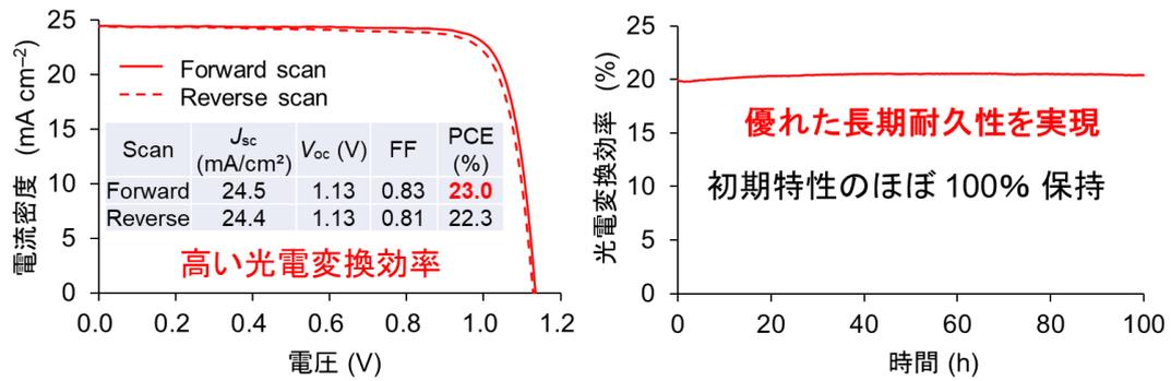
**2PATAT-C3** を用いたデバイスと比べて、ペロブスカイト界面での再結合がより抑制され、正孔回収効率が向上することが明らかになった。その結果、**3PATAT-C3** を用いたデバイスは最高で23%の効率を示すことがわかった（上図 - 左）。また、得られた太陽電池は高い耐久性を示し、不活性ガス雰囲気下で保管したデバイスは、2000 時間後でも初期とほぼ同様の特性を保持し、連続光照射条件下でも、100 時間でも初期特性のほぼ 100%を保持した（上図 - 右）。
