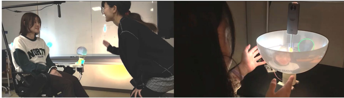
図 2．半球面を用いた遠隔車椅子介助システム．車椅子上の球面ディスプレイと遠隔介助者の半球面ディスプレイに相互の全天周カメラ映像を表示し，遠隔操作・遠隔コミュニケーション支援を行う．
