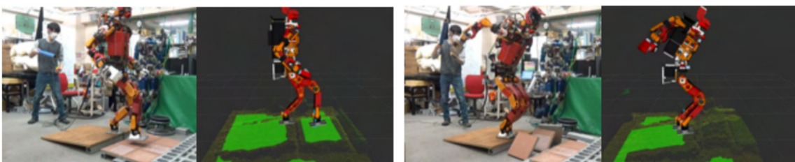
図2 足場に応じた歩容変化。左: 踏み出しによる転倒回避。右: 前方に足場がないため上半身を揺動することで転倒回避。
