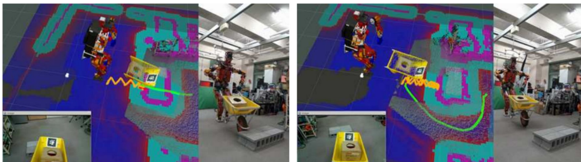
図3 一輪車運搬中の踏破性マップ更新の様子
