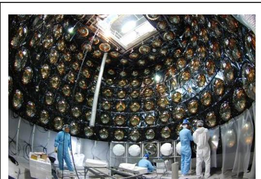
ステップ (4) に向けた光電子増倍管取り付けの様子。
