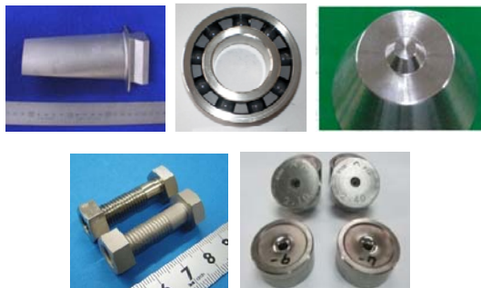
図4 Ni基超々合金製開発品。ジェット・エンジン用タービン翼(上左)、耐熱・耐食軸受(上中)、高融点硬質用摩擦攪拌接合ツール(上右)、耐熱・耐食締結部品(下左)、高温線引用ダイス(下右)
