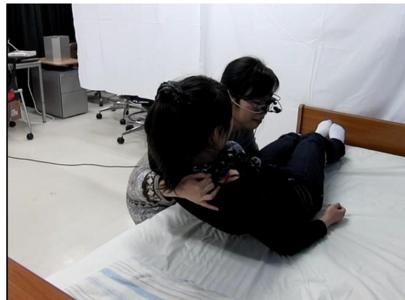
図1 介護ベッドに寝ている対象者に対して介護者である人間がアイマークレコーダで接近し、抱き上げるときの注視計測
