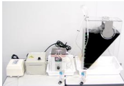
図1. ベンチスケール磁化活性汚泥実験
