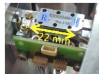
図 3 ピエゾ素子を用いた反射鏡位置調整機構
