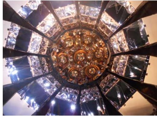
図6：ライトパイプを導入した様子。図1の上写真とほぼ同じ場所から撮影した写真。光電子増倍管がライトパイプに反射している様子がわかる。
