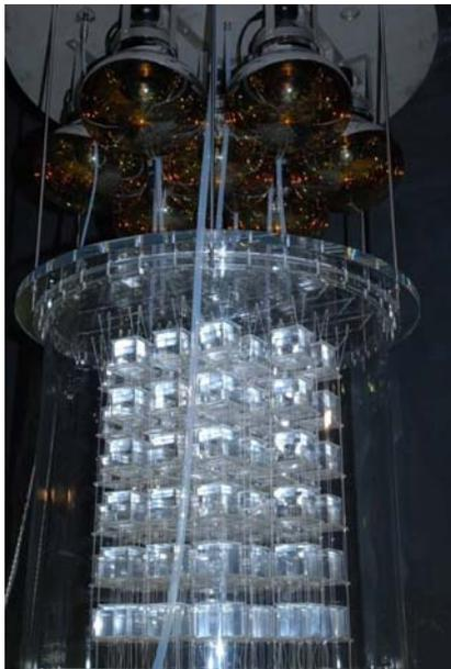
図 1 : 実験室 D に構築した CANDLES 検出器内部。上図 : 検出器の最外部にあたる水タンクの内部。光電子増倍管 55 本が取り付けられている。下図 : 検出器の中心部分に当たる  $\text{CaF}_2$  モジュールと液体シンチレータタンク。上部には光電子増倍管 7 本が取り付けられている。
