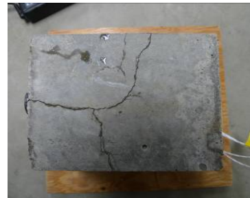
図2 誘導加熱後、試験体のひび割れ状態
