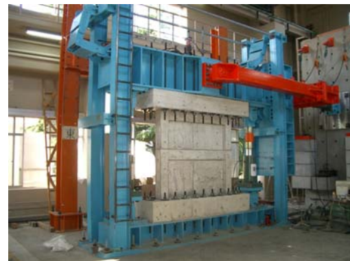
写真1 CES耐震壁の構造実験
