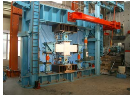
写真2 CES架構の構造実験
