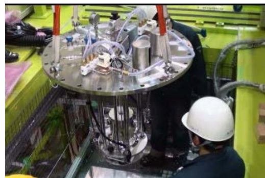
図1 試作した中性子実験用熱膨張測定装置を中性子散乱実験装置に取り付ける様子(2011年2月)
