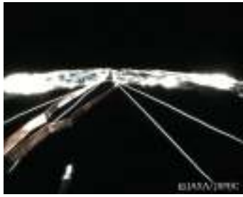
(a) 本体側面カメラによる膜面展開写真
