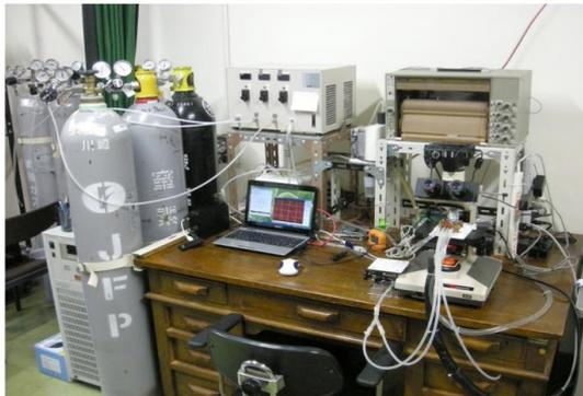
図1. ガス組成と湿度制御下で気孔開度を観察するシステムの全景
