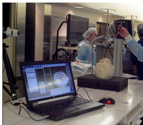
図 3 ナビゲーションシステム基礎実験 光学式位置センサ (画面左端) によりスタイラス (手で把持) の位置を読み取り、その位置をボリュームデータとともに画像上に表示するシステム
