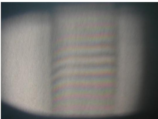
図3 白色光干渉縞（色が見えるようにアライメントをずらして撮影している）
