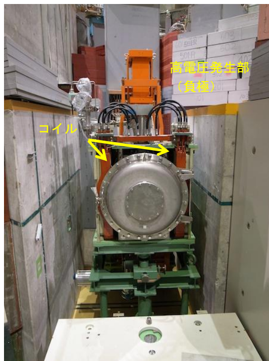
図 4 ビームラインに設置した磁場共有型の静電粒子分離装置。下流側から撮影。中央に見える封止フランジを外し下流側のビームダクトに接続する。上部に負極の高電圧発生部が取り付けられている (橙色)。
