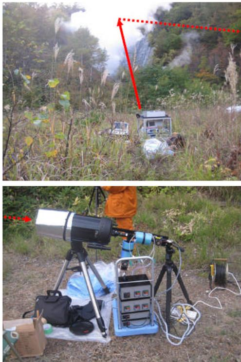
図4. 本研究で開発した、温度測定用高スペクトル分解能ライダーの外観（上：送信系，下：受信系）
