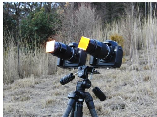
図 8. 本研究で製作した簡易型二酸化硫黄測定用分光カメラ (SO<sub>2</sub> カメラ)
