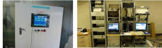
図1 (左) 富士アンテナ駆動制御装置、(上) 同観測制御・データ収集システム
