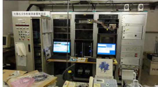
図2 木曾アンテナ観測制御・データ収集システム
