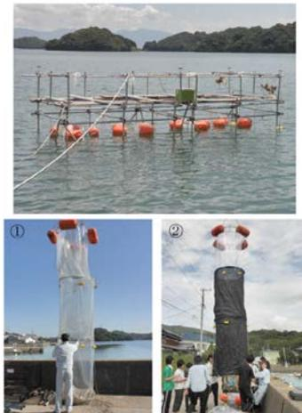
図1 メソコスム設置状況(上)と2つの異なるプラスチックバッグ。右下;下から2/3を遮光シートで覆っている。
