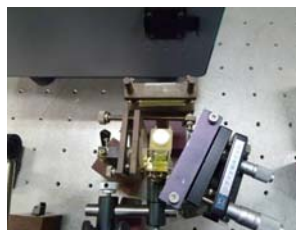
図 1. 製作した 620ps パルス色素レーザ
