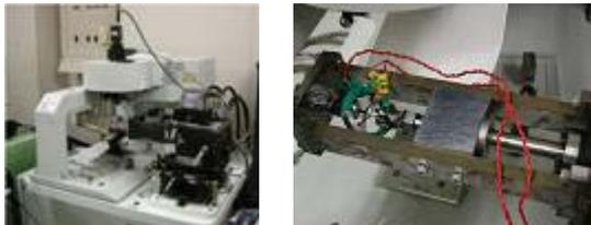
図2 本研究で開発した大気中その場観察フレットング疲労試験装置。
