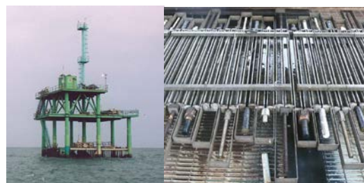
図-1 暴露施設 図-2 緊張条件下供試体
