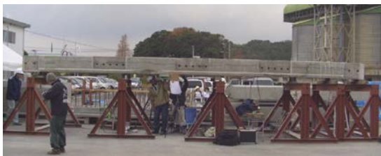
図4 プレテン PC 実験桁
