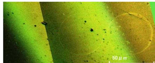
図4  $Na^+/Ag^+/NH_4^+$  のイオンを含む複層イオン交換ガラスに描画した直径  $50\mu m$  の円弧の光学顕微鏡像
