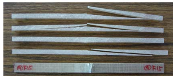
図12 突き合わせ接着部の曲げ剥離試験例
