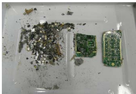
図 5 衝撃粉碎後の携帯電話プリント基板の一例
