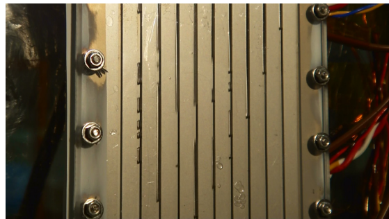
図 6. 板状 OHP の室温での動作確認
