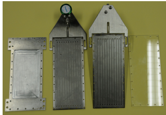
図 5. 金属板に溝加工した組立前の板状 OHP
