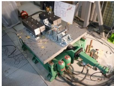
図-1 釘接合部の振動台実験
