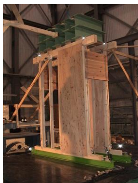
図-2 釘打ち耐力壁の振動台実験
