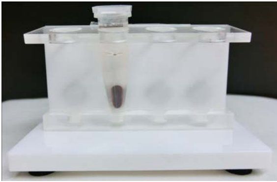
図2. 30分間軽振盪させた後の抗CD146抗体ビーズ含有血漿のマグネットスタンド固定
