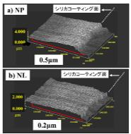
NPは約0.5 μm, NLは約0.2 μmの膜厚を示した.
