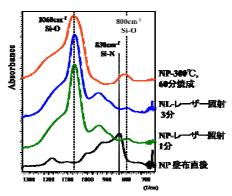
NP塗布直後は未反応PHPSの残存を示す830cm-「の Si-Nに起因するピークが認められた。 NPおよびNLにレーザーを限射すると、1060cm-「および800cm-」付近にSi-Oに起因するピークが認められ、シリカへと転化したことが示唆された。
